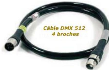
Au-delà de 20 ou 25 mètres de liaison DMX, il est recommandé de boucler l'extrémité de la ligne avec un bouchon DMX (une petite résistance de 120  $\Omega$  qui évite le retour des informations en amont, ce qui parasiterait la transmission des informations)
